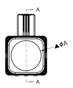
$\varnothing$ A= $\varnothing$ 8.50 $\pm$ 0.10mm
